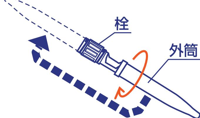
外筒を左に回転させて抜き取り、栓の反対側に取り付けます。
